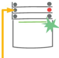
2. Drücken Sie die linke LED (Segmenttaste), die sie unscharf schalten möchten
